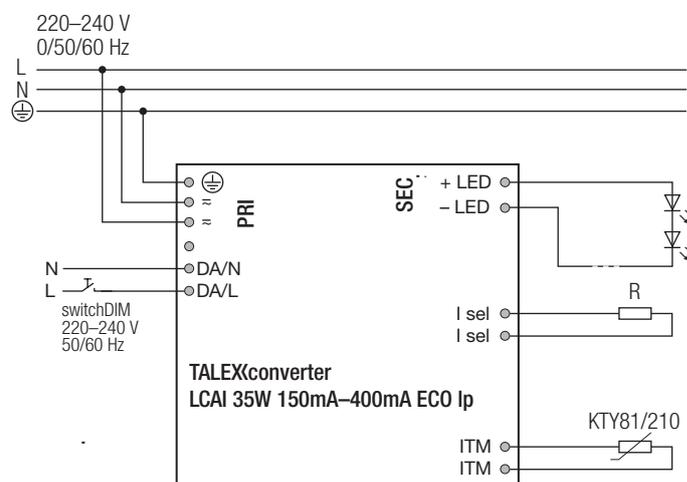
Diagramme LCAI 35W 150mA-400mA ECO Ip
