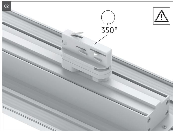
**02** Vor dem Einsetzen in die Stromschiene prüfen, alle Kunststoffverriegelungen und Kontakte müssen bündig im Adapter sein! **Schaltpositionen müssen in Nullstellung sein!** Bei Nichtbeachtung wird der Adapter zerstört und darf nicht mehr verwendet werden!
