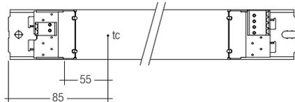
Der tc Punkt und ta Temperaturangabe liegt die Nennlebensdauer zugrunde. Die Abhängigkeit der tc zur ta Temperatur hängt auch vom Design der Leuchte ab. Falls die gemessene tc Temperatur ca. 5 K unter tc max. liegt, soll die ta Temperatur geprüft werden und bei Bedarf die kritischen Bauteile (z.B. ELKO) gemessen werden.
