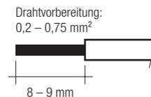
Lösen des Leiters mittels geeigneten Werkzeug (z.B. Microcon Lösestift) oder durch drehen und ziehen.
