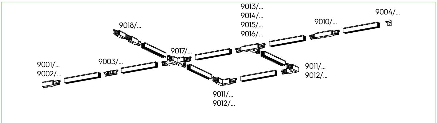
Ein mechanischer Schlüssel im Profil der Schiene gewährleistet den richtigen Anschluß der jeweiligen Verbinder.
