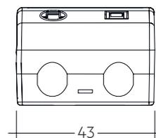
Zulässiger Durchmesser des Kabelmantels: 2,2 – 9 mm
