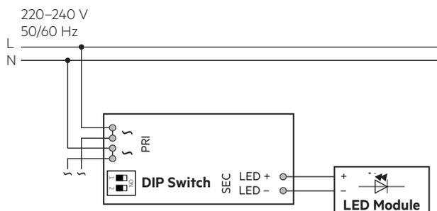
Gerät mit Durchgangsverdrahtungsfunktion.
