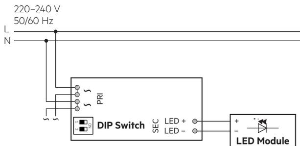
Gerät mit Durchgangsverdrahtungsfunktion.
