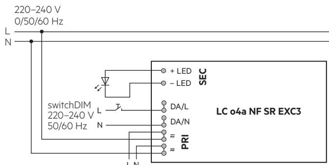
Gerät mit Durchgangsverdrahtungsfunktion.
