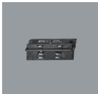
79329.000 3-Phasen-T-Verbinder Kunststoff. Schutzleiter links. Einspeisung möglich. Durchverdrahtung. Schwarz 🔌 ⚠️ ENEC CE ⚠️
