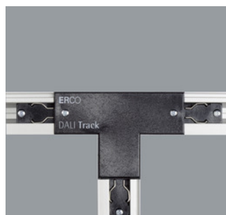
79228.000 DALI T-Verbinder Kunststoff. Schutzleiter rechts. Einspeisung mög- lich. Durchverdrahtung. Schwarz EAC CE
