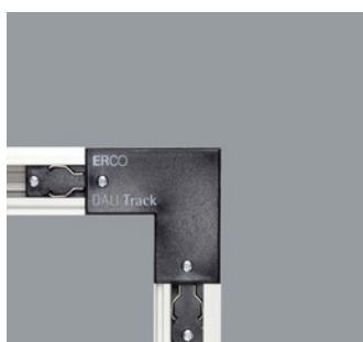
79226.000 DALI Eckverbinder Kunststoff. Schutzleiter innen. Einspeisung möglich. Durchverdrahtung. Schwarz EAC CE
