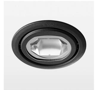
Einbauleuchte mit LED, Bemessungslebensdauer der LED L80/B10 > 50000 h, Farbwiedergabeindex CRI > 82, Farborttoleranz 2 SDCM (initial), Reflektor mit ovalem Lichtbild, Reflektor Reinstaluminium 99,99% in MIRO-Silver®, Drehwinkel 170°, Schwenkwinkel +/-30°, Leuchtengehäuse Stahlblech, pulverbeschichtet, schwarz, separate Treibereinheit
