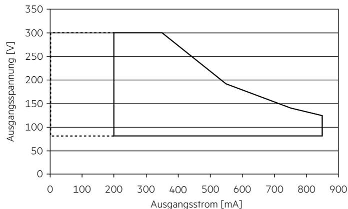
Es ist sicherzustellen, dass der LED-Treiber ausschließlich innerhalb des gezeigten Arbeitsfensters betrieben wird.
