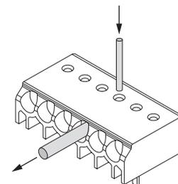
Draht lösen durch Drehen und Ziehen oder Verwendung eines Lösewerkzeugs Ø 1 mm
