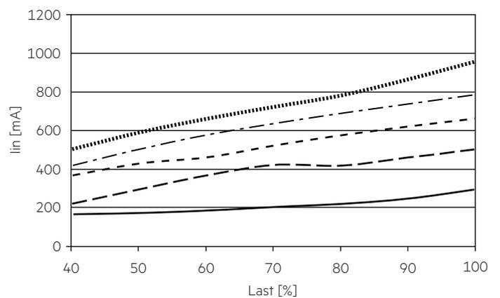
**4.4.3 Eingangsstrom in Abhängigkeit zur Last 277 V, 60 Hz**
