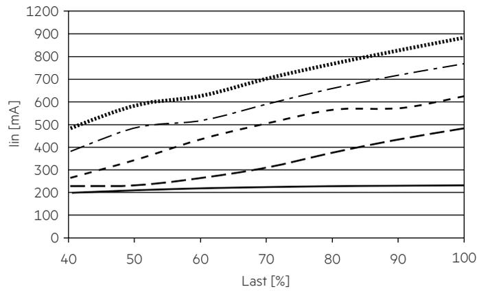
**4.5.3 Eingangsleistung in Abhängigkeit zur Last 277 V, 60 Hz**
