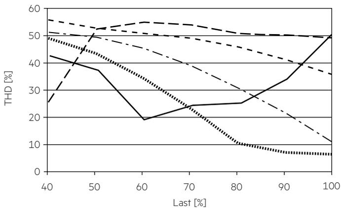
**4.4.2 Eingangsstrom in Abhängigkeit zur Last 230 V, 50 Hz**
