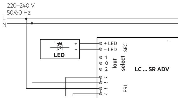
Gerät mit Durchgangsverdrahtungsfunktion.
