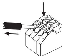
Dazu den "Drücker" an der Klemme betätigen und den Draht nach vorne abziehen.
