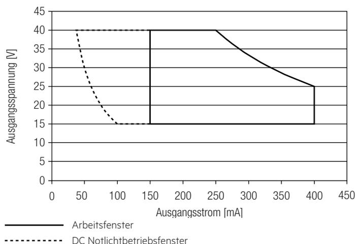
Es ist sicherzustellen, dass der LED-Treiber ausschließlich innerhalb des gezeigten Arbeitsfensters betrieben wird. Besondere Aufmerksamkeit ist dem gedimmten Betrieb sowie dem DC- und Notlichtbetrieb zu widmen, da aufgrund der verwendeten Amplituden-Dimmung die Modulspannung mit dem Dimm-Level variiert. Eine Unterschreitung der spezifizierten minimalen Ausgangsspannung des LED-Treibers kann zur Abschaltung führen. Siehe Abschnitt „6.7 DC- und Notlichtbetrieb“ für mehr Informationen.
