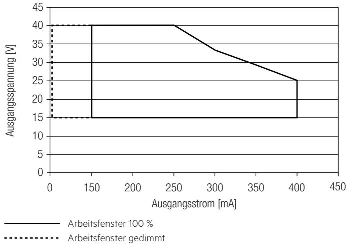
Es ist sicherzustellen, dass der LED-Treiber ausschließlich innerhalb des gezeigten Arbeitsfensters betrieben wird. Besondere Aufmerksamkeit ist dem gediminten Betrieb sowie dem DC- und Notlichtbetrieb zu widmen, da aufgrund der verwendeten Amplituden-Dimmung die Modulspannung mit dem Dimm-Level variiert. Eine Unterschreitung der spezifizierten minimalen Ausgangsspannung des LED-Treibers kann zur Abschaltung führen. Siehe Abschnitt „6.11 Lichtlevel im DC-Betrieb“ für mehr Informationen.
