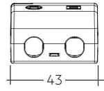
Erlaubter Kabelmantel-durchmesser: 2,2 – 9 mm
