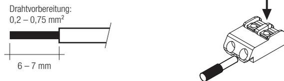
Lösen der Klemmenverdrahtung
