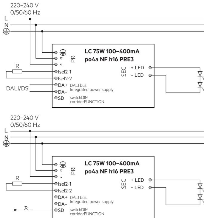
Die Netzspannungsphase für den switchDIM / corridorFUNCTION muss zwingend von der gleichen Phase erfolgen wie am Netzspannungseingang des Treibers. In switchDIM Anwendungen darf das DALI Interface sowie die integrierte DALI-Bussspannungsversorgung (IPS) nicht verwendet werden.
