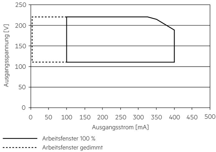
Es ist sicherzustellen, dass der LED-Treiber ausschließlich innerhalb des gezeigten Arbeitsfensters betrieben wird. Besondere Aufmerksamkeit ist dem gedimten Betrieb sowie dem DC- und Notlichtbetrieb zu widmen, da aufgrund der verwendeten Amplituden-Dimmung die Modulspannung mit dem Dimm-Level variiert. Eine Unterschreitung der spezifizierten minimalen Ausgangsspannung des LED-Treibers kann zur Abschaltung führen. Siehe Abschnitt „6.8 DC-Betrieb“ für mehr Informationen.
