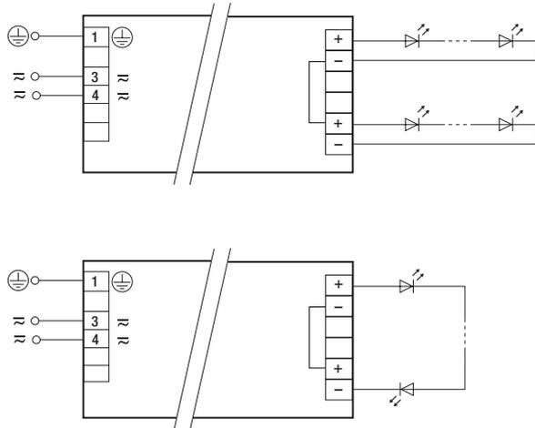
Für die korrekte Funktion müssen die LED's wie oben gezeigt angeschlossen werden. Die beiden Kreise dürfen eine unterschiedliche Anzahl an LED's enthalten (wie auf der oberen Abbildung gezeigt). Die Minimallast muss angeschlossen werden. Das LED-Betriebsgerät würde ansonsten abschalten.
