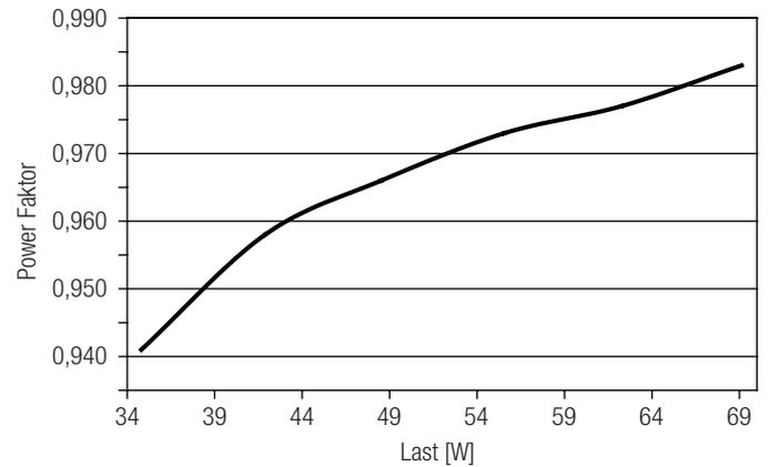
Eingangsleistung in Abhängigkeit zur Last
