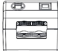
Sekundäre Zugentlastung für Kabel mit kleinerem Kabelmantel
