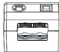
Sekundäre Zugentlastung für Kabel mit kleinerem Kabelmantel
