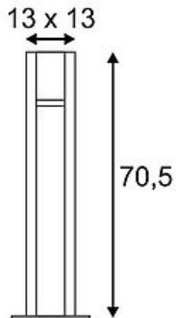
Indirekt abstrahlende Stehleuchte SLOT der Arrock Serie bestehend aus dem Naturprodukt Granit. Somit wird jede Leuchte zu einem unvergleichlichem Unikat. Mit ihrer Schutzart IP44 ist sie für den Außenbereich geeignet. Zur einfachen Montage ist optional ist ein Erdspeiß verfügbar. Der Anschluss erfolgt an 230V Netzspannung. Diese Leuchte ist geeignet für Leuchtmittel der Energieklassen: A - A++
